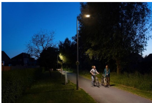
Ilustración 4. La iluminación de fijación lateral permite descentrar el haz de luz al centro de la vía ciclista. Recuperado de https://www.schreder.com/en/projects/sustainable-self-supporting-lighting-mandel-bike-path
