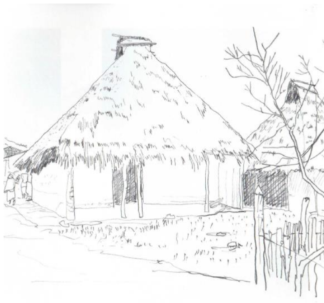
Estructura con techo de caballete, cuya inclinación es bastante pronunciada; el orificio superior facilita la salida del humo. San Juan Chamula
